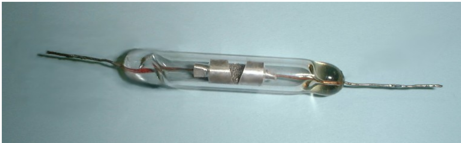
初期の実用型コヒーラ構造
